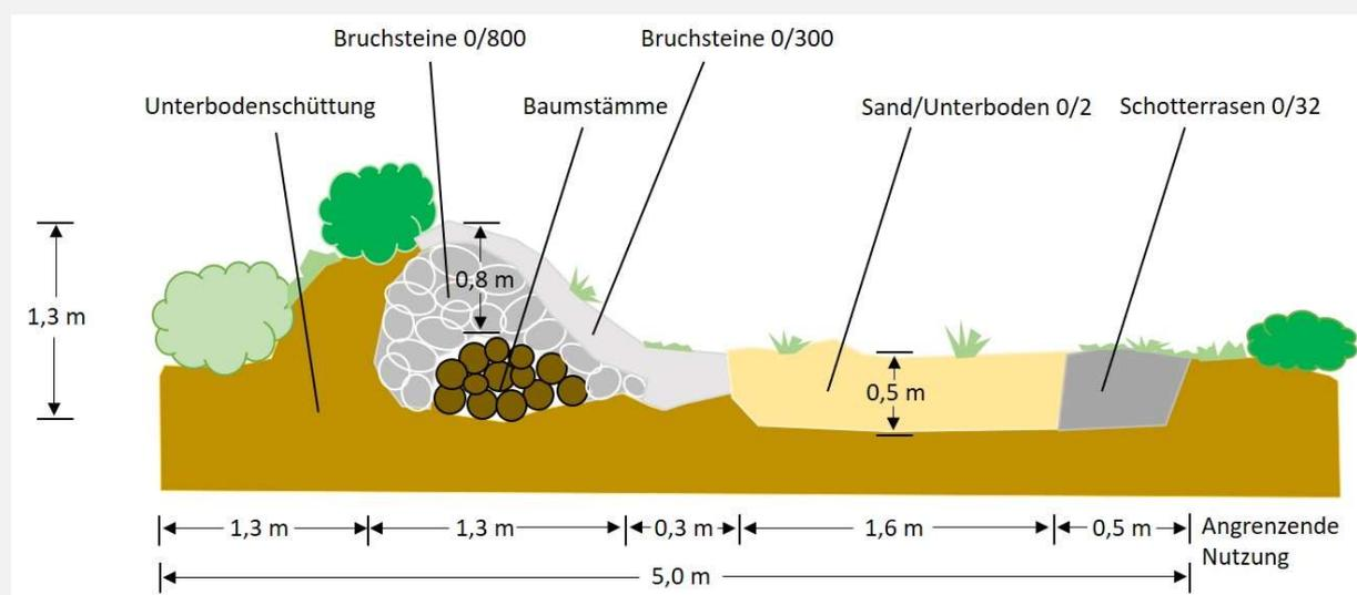
**Abb. 10:** Schematischer Aufbau eines Steinriegelkomplexes mit Winterquartier, Verwaltung und integriertem Eiablage substrat. Als Winterquartier dienen frostfrei eingebaute Totholzelemente.
